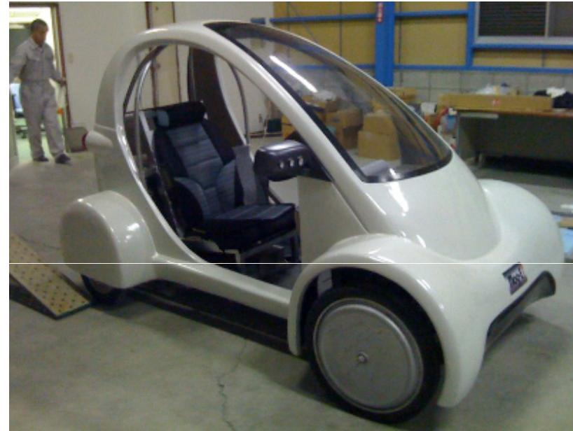
ドアミラーやランプ類の取り付け、ウィンド外周のテーピング（接着剤隠し）、ステッカー貼付などを行いボディ完成である。
