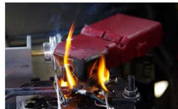
写真5-7 自動車Cのショート火災再現状態
