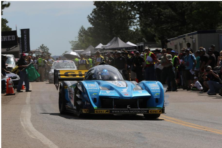
TEAM APEV with MONSTER SPORT では、4年目のチャレンジにあたって新型マシン"Tajima Rimac E-Runner Concept\_One"を新規開発し投入した。開発は短期間だったが、将来の市販車に繋がる技術を導入し、1.1MW(メガワット:約1500PS)もの最高出力ながら、四輪トルクベクトル制御によって、安全で速く走れる、電気自動車の究極的高性能を追求したマシンだ。
